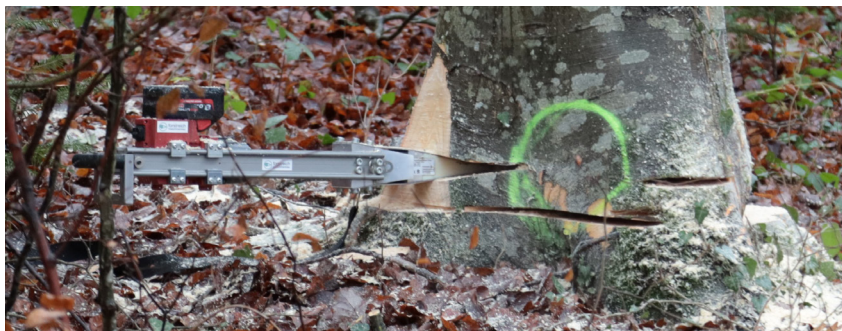
Le coin d'abattage télécommandé renforce la sécurité lors de la coupe.
